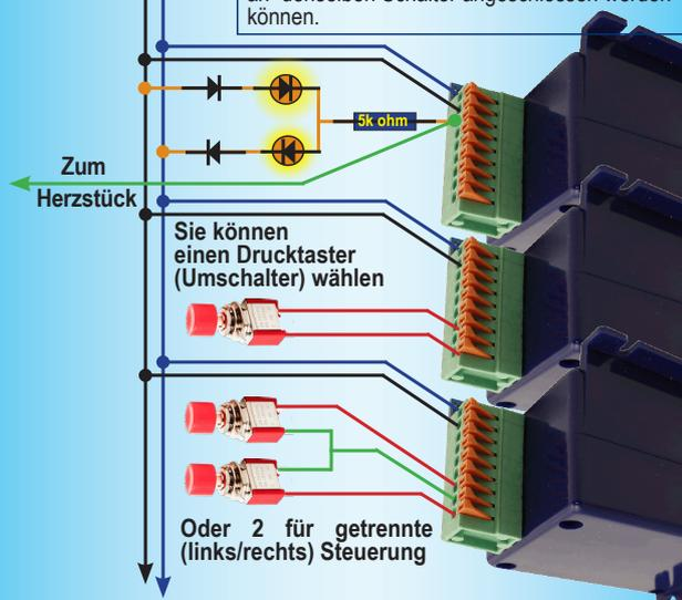
Auch wenn Sie LEDs und Drucktaster angeschlossen haben, besitzen Sie immer noch einen freien Wechselschalteranschluss um Signale, Gleisperrfunktion oder andere Funktion zu bedienen.
