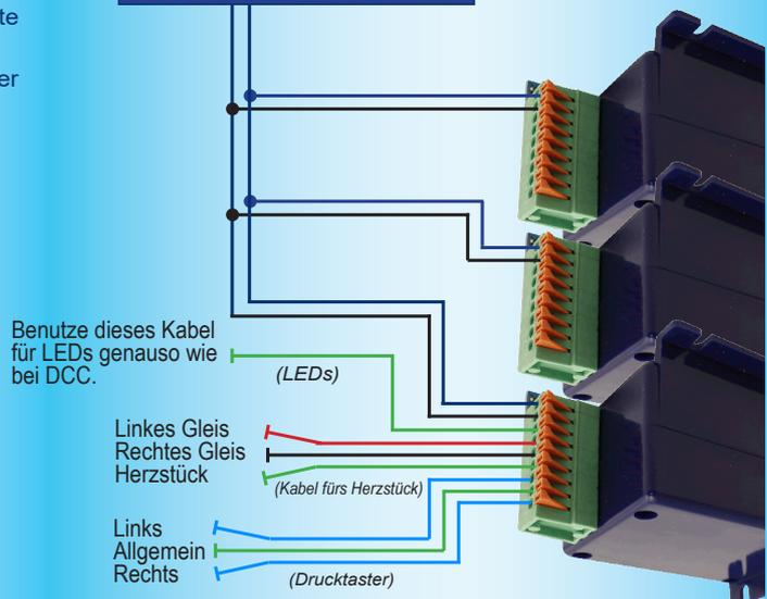
Wenn Löten nicht Ihr Ding ist, ist der Cobalt iP Digital der ideale Weichenantrieb für Sie!! Alle Anschlüsse sind Clipanschlüsse und die integrierten Schalter machen die Herzstückpolarisierung sehr einfach!
