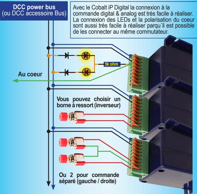
**Si vous avez connecté les LEDs et les bornes à ressort, vous avez encore une connexion au commutateur pour commander les signals, enclenchement ou d'autres fonctions.**
