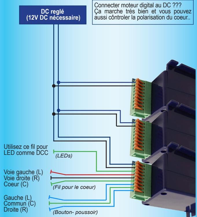
**Vous n'aimez pas la soudure? Alors vous avez trouver le moteur ideal pour vous. Cobalt iP Digital!! Tous connexions sont des bornes à ressort et par les commutateurs intégrés la polarisation du coeur est completement facile à réaliser !**
